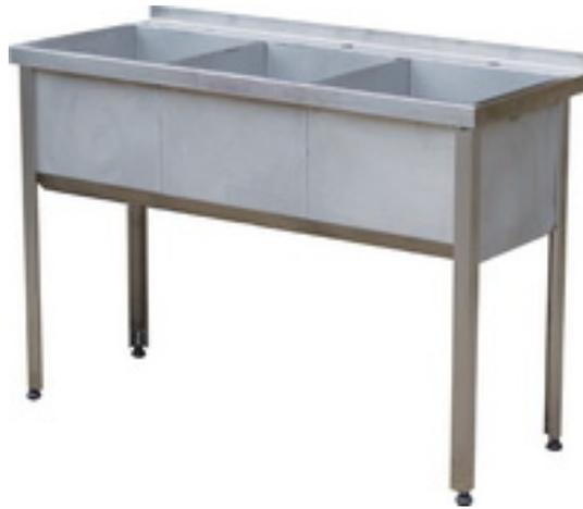
Ванна моечная 3-х секционная ВМБЦ 32/50, емкость ванны сварная из нерж стали AISI 304, t=0,8 мм, с задним бортом, ножки съемные из нерж. стали, размер секции 500\*500\*350 мм, габаритные размеры 1550\*600\*860 мм.
